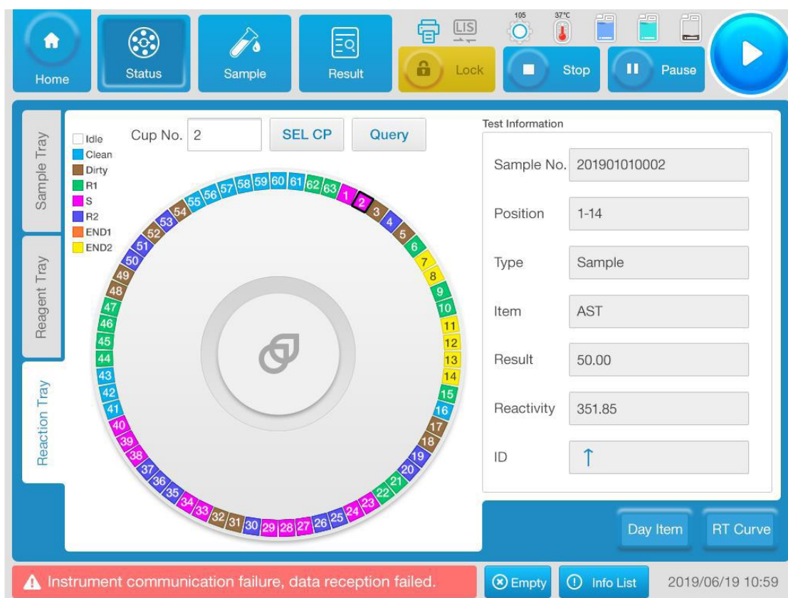
Рисунок 4-7 Состояние реакционного ротора
